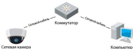
Рисунок 3-2 Соединение через коммутатор или роутер
