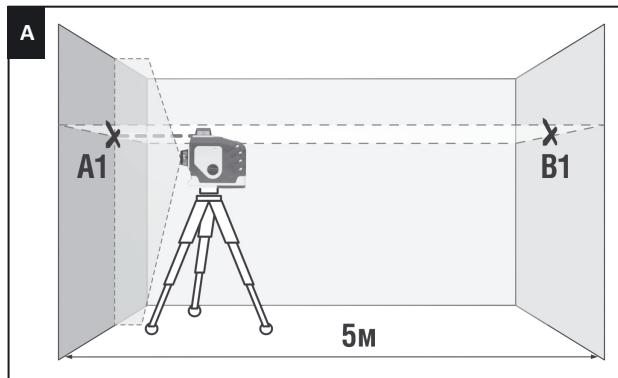
2. Поверните прибор на 90°, измерьте отклонение оси луча от отметки B1 (см. рис. В). Если отклонение превышает 1,5 мм – обратитесь в сервисный центр.
